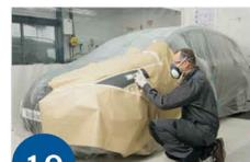
**19** Auftragen von Haft- und Korrosionsschutzgrundierung
