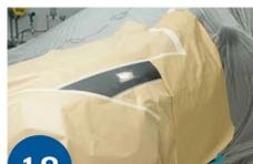
**18** Abdecken der Lackierfläche zum Füllerauftrag
